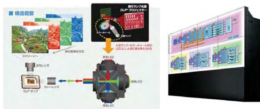
図-5 LED-DLP方式プロジェクタ構造概要
